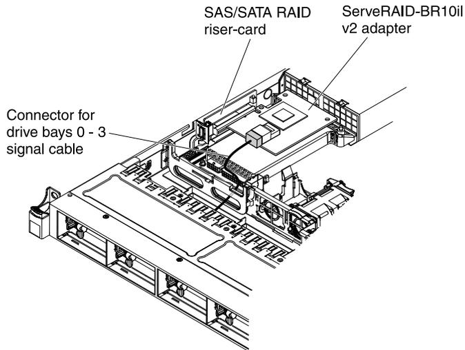
Figure 46. ServeRAID-BR10i v2 adapter cable connection
